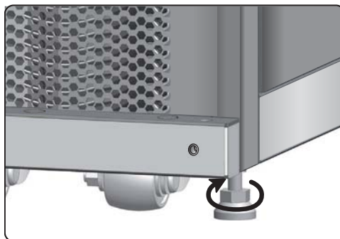
Рис. 3-3 Поверните каждую опору по часовой стрелке
