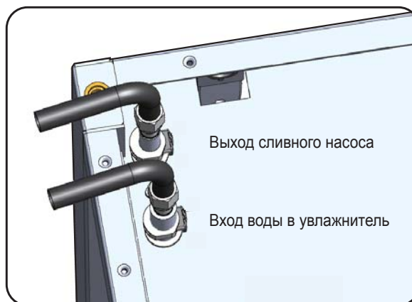
Рис. 3-10 Подсоединение труб к выходу сливного насоса и входу увлажнителя
