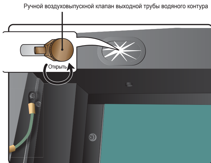
Рис. 4-3 Откройте ручной воздуховыпускной клапан выходной водяной трубы
